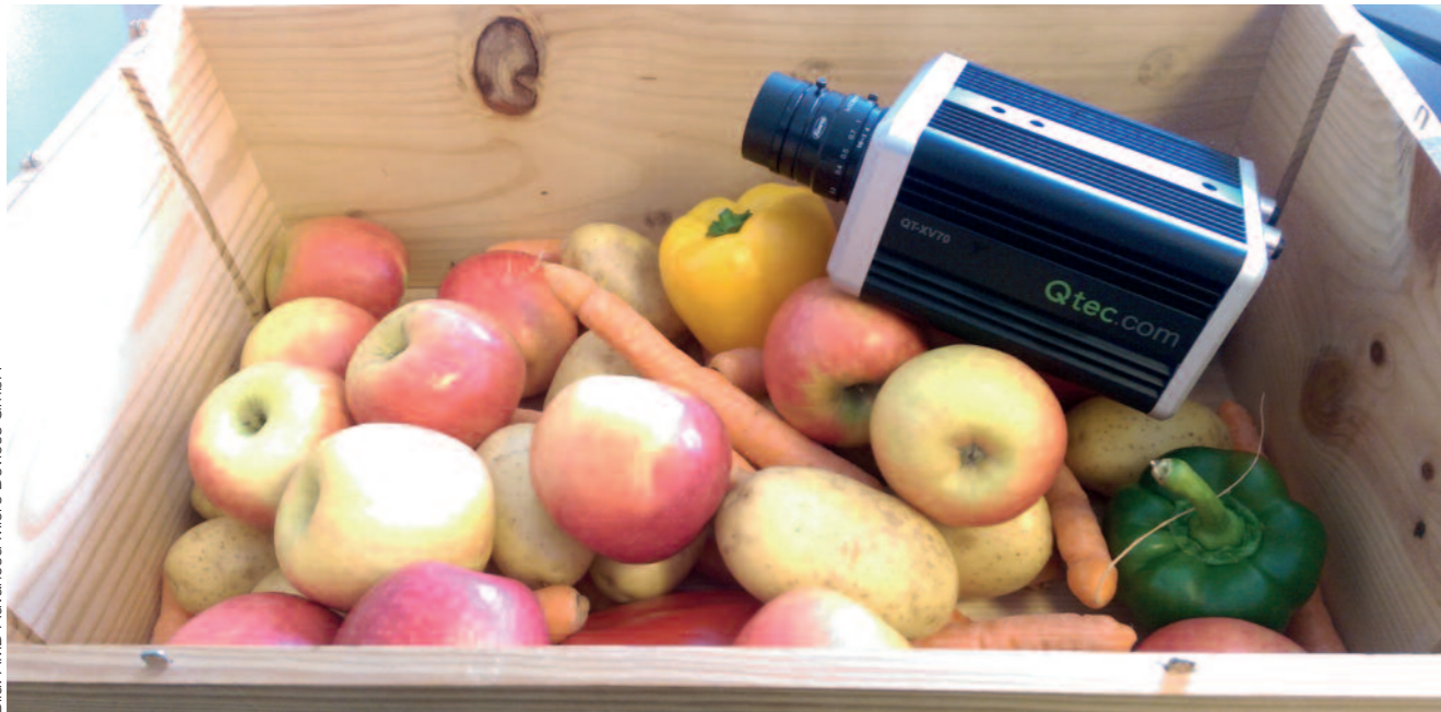
Bild 2 | Mit den intelligenten Kameras von Qtechnology lässt sich Obst und Gemüse klassifizieren. Die Kamera kann mit unterschiedlichen Kameraköpfen ausgestattet werden, u.a. für Hyperspectral Imaging.
