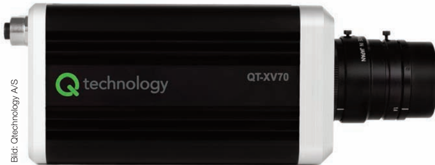
Bild 2 | In der intelligenten Kamera von Qtechnology übernimmt eine AMD Embedded G-Series APU die Berechnungen auf den höheren Ebenen. Ein kostengünstiger FPGA nimmt die Sensorsignale entgegen und übernimmt das Bild-Preprocessing.
